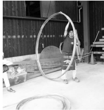
写真3 竹の箍を組む（撮影：牧野久実）
