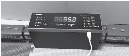
図9 鉄道模型の速度計測装置による表示
