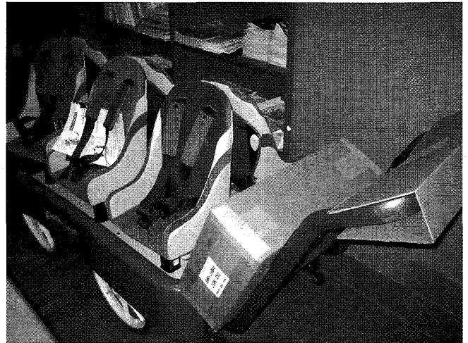
写真5 6人乗りベビーカー（座席が背中合わせになっていて片側3人、計6人）
