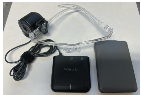
写真1 ウェアラブルカメラのシステム構成
